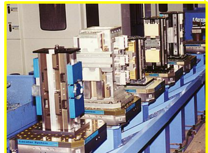
FMS compuesta de varios centros de mecanizado y un sistema de transporte de piezas.
