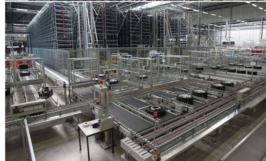
Sistema de gestión de ruedas para modelos A3 y A4 de Audi: Se suministran diferentes tipos de ruedas
