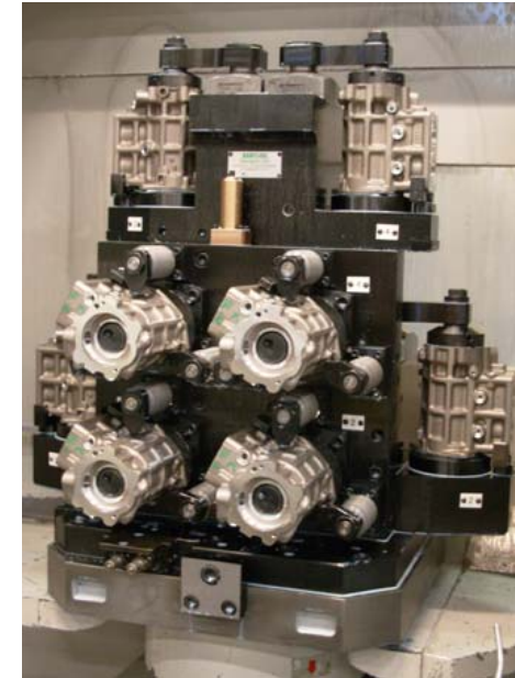
Empleo de sistemas de amarre comunes para varias piezas de la misma familia.
