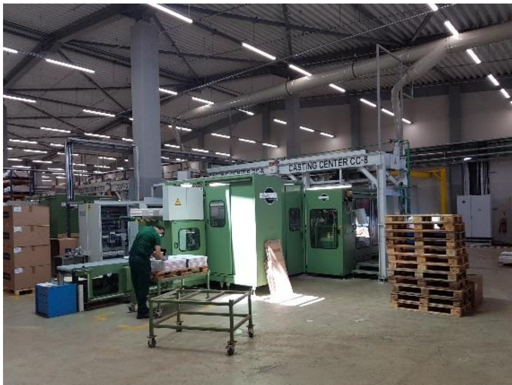
Φωτογραφία 15.10: Άποψη του χώρου έγχυσης μολύβδου με μηχανές CASTING.
