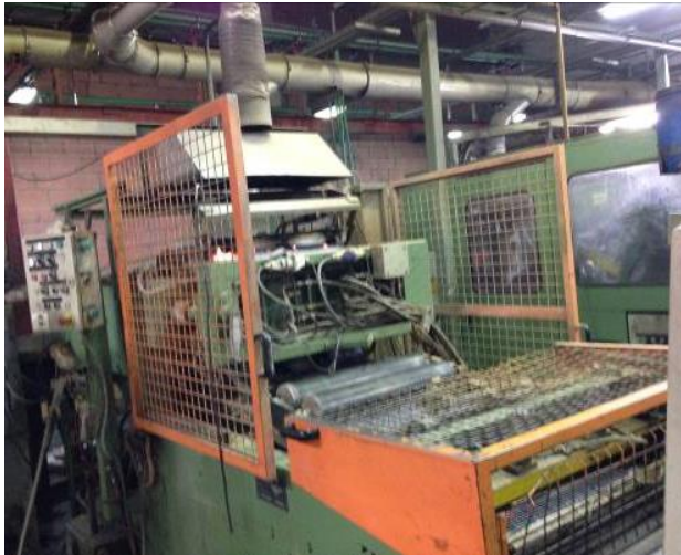
Εικόνα 6.1: Χυτόπρεσα τύπου «Hadri» που χρησιμοποιείται στη μονάδα για την παραγωγή θετικών πλεγμάτων. Εικόνα 6.2: Παραγωγή θετικών πλεγμάτων μολύβδου από τις χυτόπρεσες.
