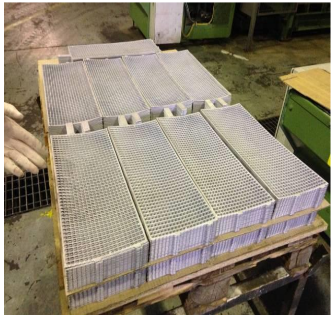
Εικόνα 6.4: Παραγωγή αρνητικών πλεγμάτων μολύβδου από τις μηχανές χύτευσης.
