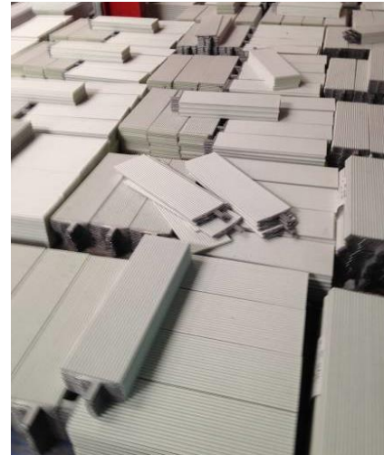
Εικόνα 6.1: Χυτόπρεσα τύπου «Hadri» που χρησιμοποιείται στη μονάδα για την παραγωγή θετικών πλεγμάτων. Εικόνα 6.2: Παραγωγή θετικών πλεγμάτων μολύβδου από τις χυτόπρεσες.
