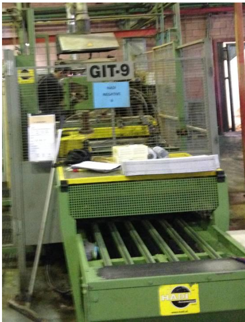
Εικόνα 6.3: Μηχανή χύτευσης τύπου «Hadi» που χρησιμοποιείται στη μονάδα για την παραγωγή αρνητικών πλεγμάτων
