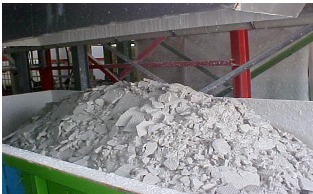
Εικόνα 6.9: Στερεό ίζημα του συστήματος επεξεργασίας υγρών αποβλήτων από τη ΜΕΥΑ 1 (ΕΚΑ 19 08 14).
