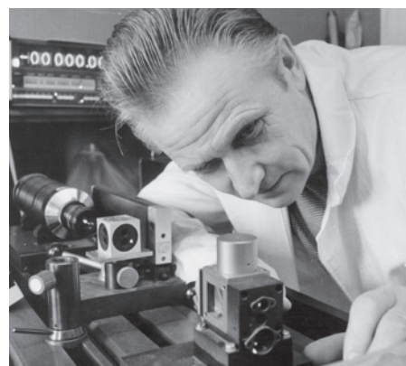
J. Kršek při nastavování laserového interferenčního měřiče délek v laboratoři ÚPT ČSAV
