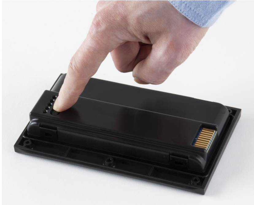
Abbildung 2-5: Überprüfen der verbleibenden Akkuladung
