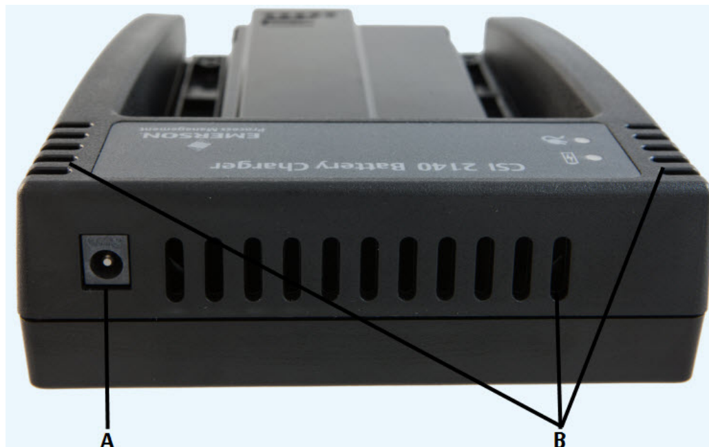
Abbildung 2-6: Netzanschluss und Lüftungsschlitze
