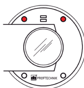
Abbildung 7-14: LEDs zum Einstellen des Laserstrahls
