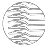
Abb. 3.18 Faltenbalg mit geschweißten Blättern
