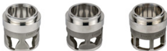
Abb. 1.7 Käfige (links nach rechts): Linear, Gleichprozentig, Schnellöffnend
