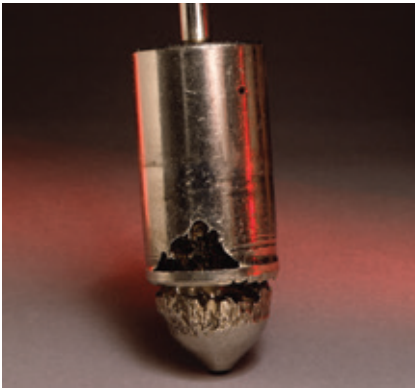
Abb. 5.8 Typisches Erscheinungsbild eines Schadens durch Flashverdampfung
