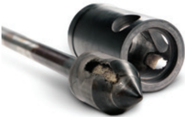
Abb. 5.9 Typisches Erscheinungsbild eines Schadens durch Kavitation
