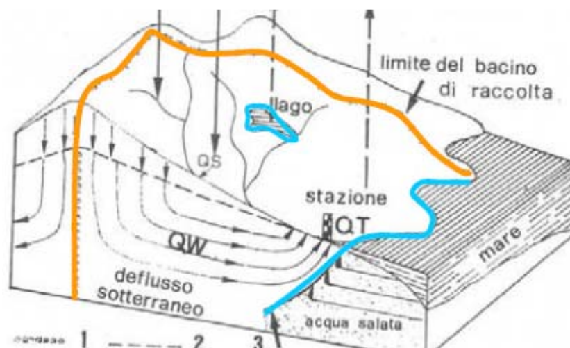
Figura 2 – Delimitazione del sistema idrologico (in blu i limiti fisici, in arancione i limiti idrologici, da Castany rielaborato da Alberti)
