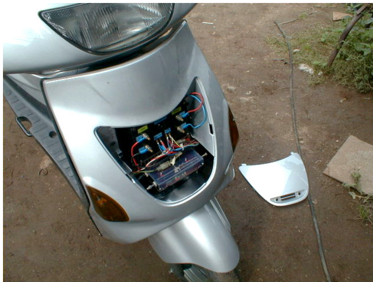
Obr. 2 Detail zdroje 48V/12V a mechaniky ovládání plynu
