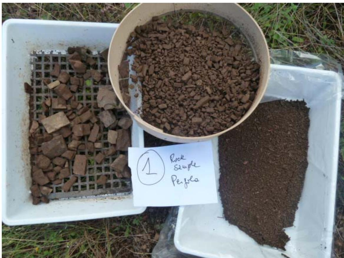
**Figura 9.** – Il campione prelevato al punto di campionamento n. 1: da Sx a Dx il sopravaglio a 2 cm, lo scheletro tra 2 cm e 2 mm e poi il “passante” a 2 mm, da rifinire in Laboratorio.
