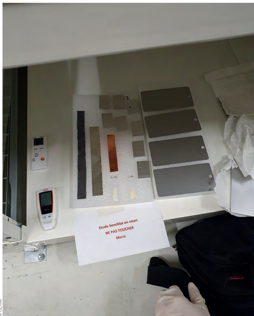
Coupons métalliques témoins (argent, fer, cuivre, plomb, aluminium) et capteurs placés dans les réserves du Musée national de la marine (action 3 du projet SensMat).
