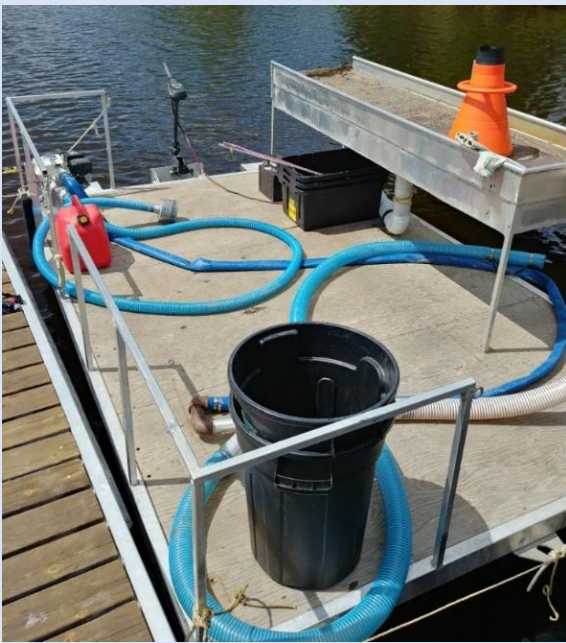
Plateforme flottante avec appareil de succion (photographie : Vincent Gagné)
