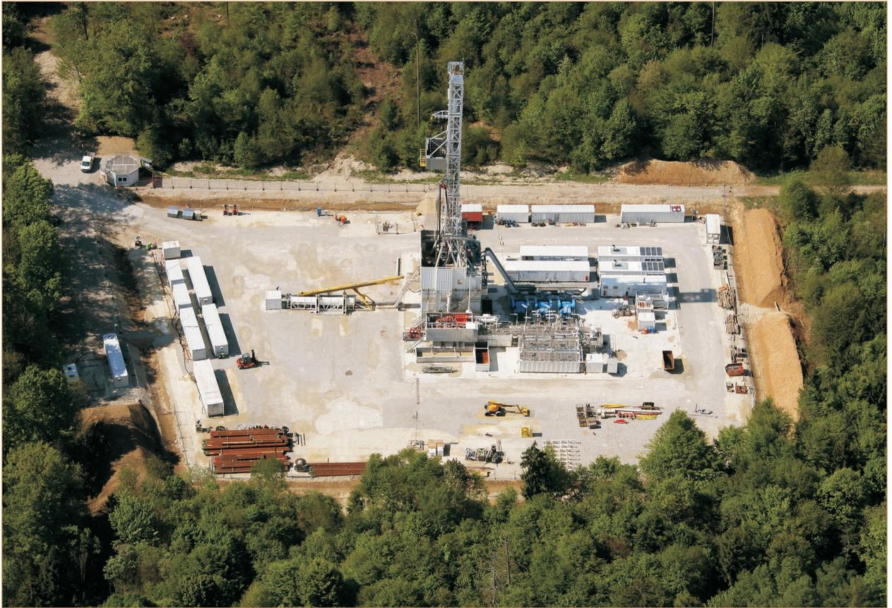
Abb. 5: Projekterweiterung Pullach. Bohranlage (Hekla Rig 002) während der Bohrabreiten zur Erweiterungsbohrung PullachTh3 im Frühjahr 2011 (Luftbild: Hekla Energy GmbH) ■
