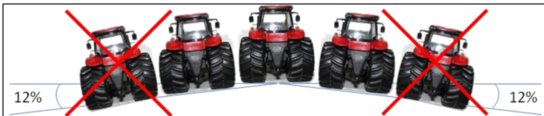
Figura 12 - Recomendação de declividade lateral de maquinário.
