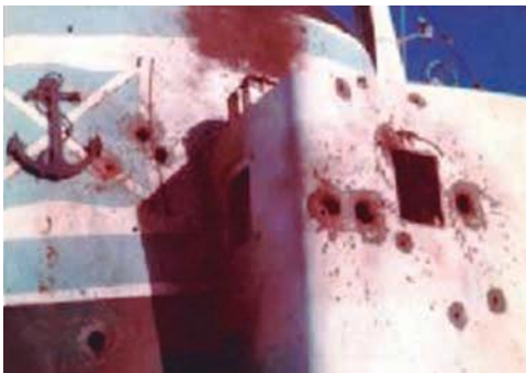
Daños en la superestructura del ELMA Río Carcarañá
