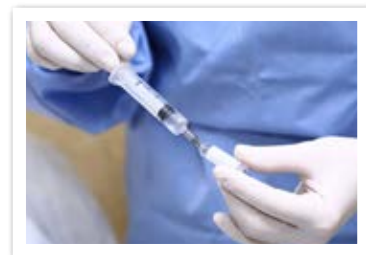
Obr. 2 – Důkaz nestlačitelnosti kapalin
