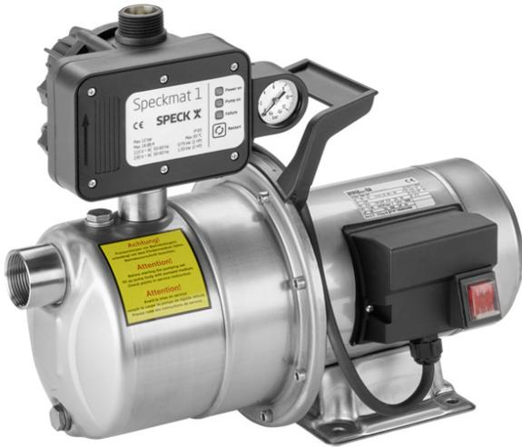
Das Schaltgerät schaltet bei einem Druck unter 2,2 bar die Pumpe ein und bei Erreichen des Enddruckes, bei Trockenlauf oder bei einem Verbrauch von weniger als 0,6 l/min, aus. Der Einschaltdruck ist nicht veränderbar. Zwischen Ein- und Ausschaltdruck muss mindestens ein Druckunterschied von 0,7 bar liegen.
