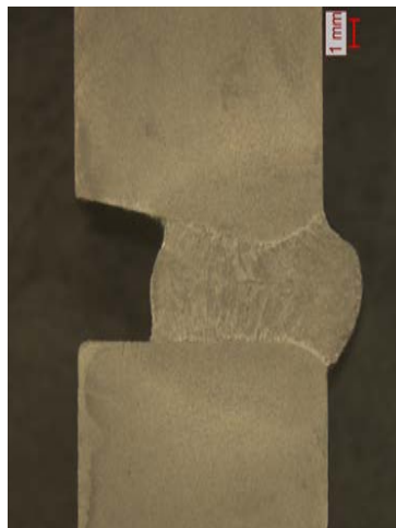
Blechdicke 10 mm, Fase einseitig 15 Grad, Luftspalt 4 mm
