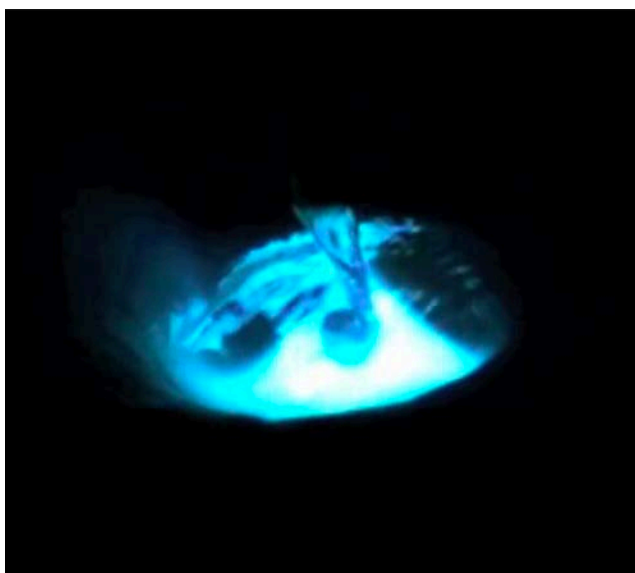
Bild 23: Tropfenübergang beim Sprühlichtbogen
