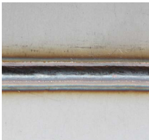
Schweißen von hochlegierten Blechen
