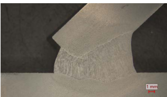
Blechedicke Stegblech 10 mm, Öffnungswinkel 35°
