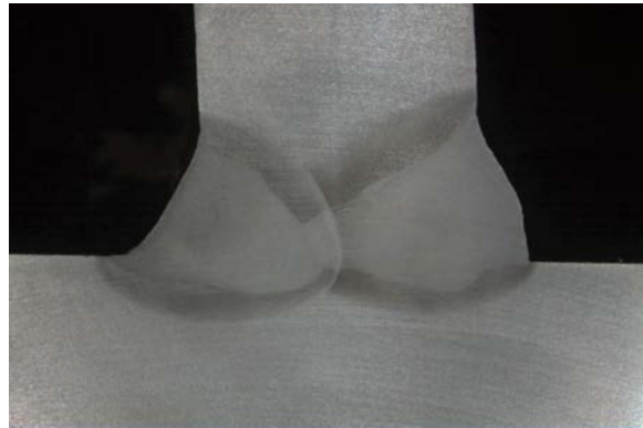
Vollanschluss beidseitig geschweißt
