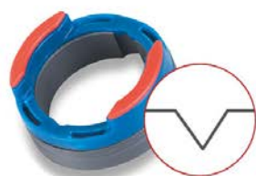
z. B. UNI-Rollen für \varnothing 1 mm bis 1,2 mm mit V-Nut (blau/rot) für Edelstahl, Stahl
