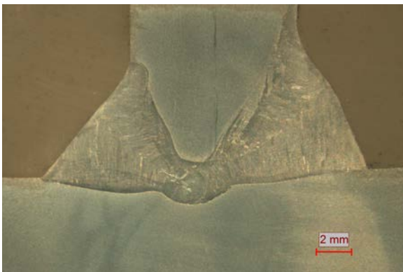
Vollanschluss beidseitig geschweißt
