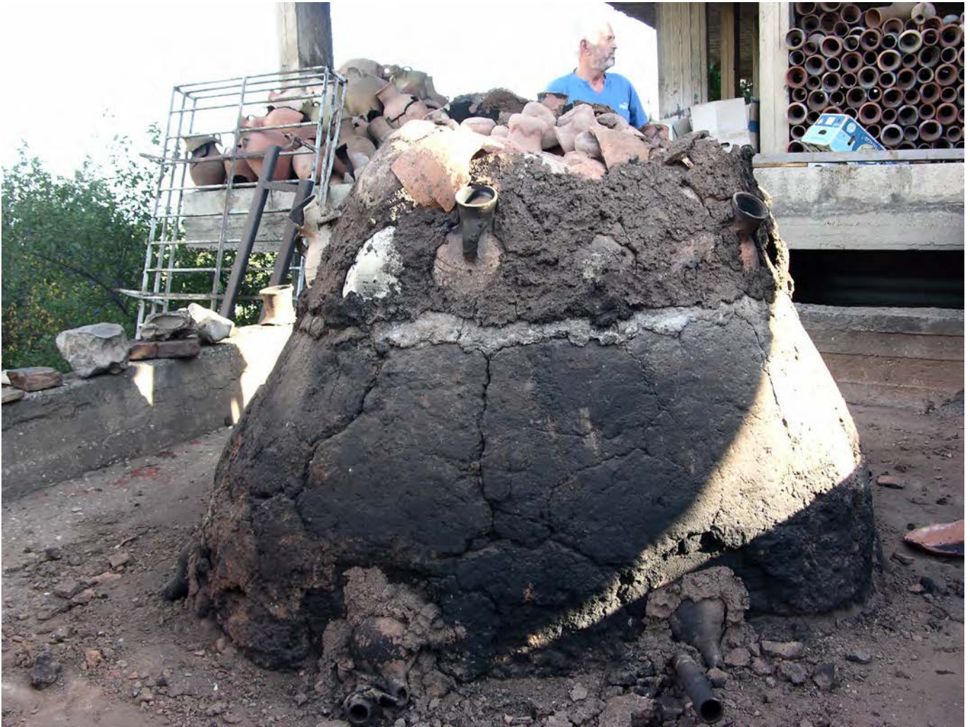
Figura 6. Cierre superior del horno de cerámica de un alfar tradicional en Burjein (Líbano; foto: archivo del Polish Centre of Mediterranean Archaeology de la Universidad de Varsovia).
