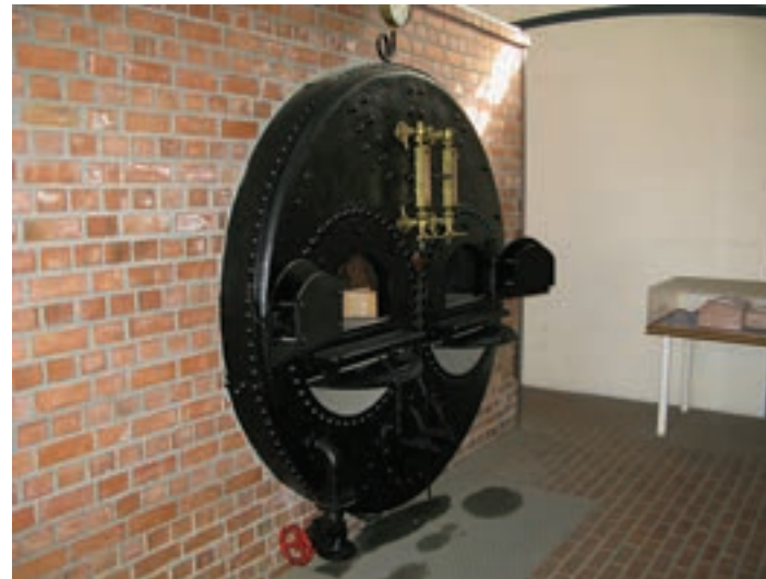
Εικ. 293. Εμπρόσθια όψη του ατμολέβητα, όπως έχει αναπαλαιωθεί στο μουσείο
