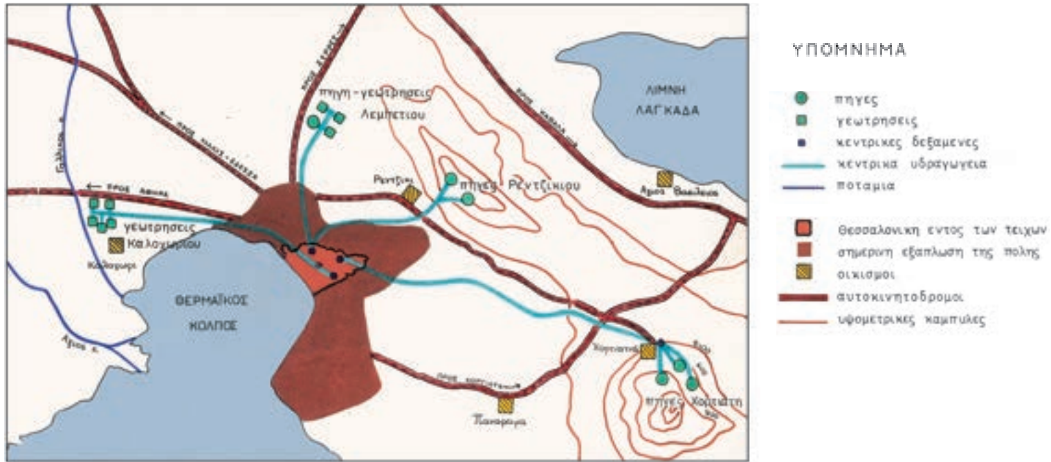
Εικ. 9. Τοπογραφικό σακάρφημα της ευρύτερης περιοχής της Θεσ/νίκης με τα υδραγωγεία, που απεικονίζει την ύδρευση από τα ρωμαϊκά χρόνια μέχρι το 1888
