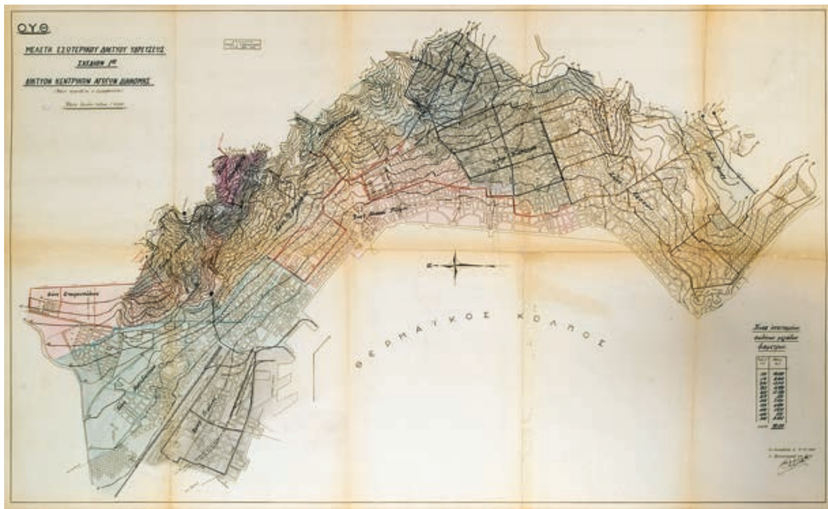
Εικ. 154. Χάρτης του 1954 με τους κεντρικούς αγωγούς υδροδότησης της Θεσσαλονίκης
