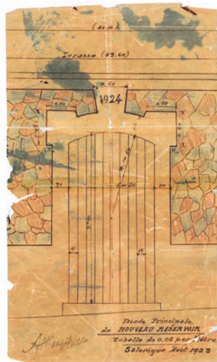
Εικ. 104. Τεχνικό σχέδιο της εισόδου της δεξαμενής Καλλιθέας
