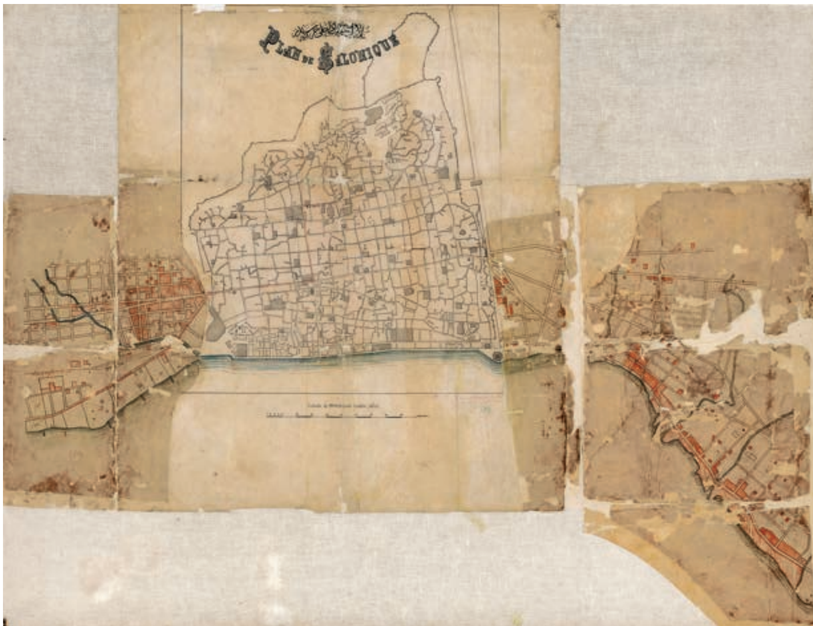
Εικ. 94. Τοπογραφικό Θεσσαλονίκης του 1870, όπου με την κόκκινη μολυβιά φαίνεται η πρώτη χάραξη της διαδρομής του αγωγού από το Κ.Α.Σ. μέχρι την Κασσάνδρου και τη δεξαμενή Βλατάδων
