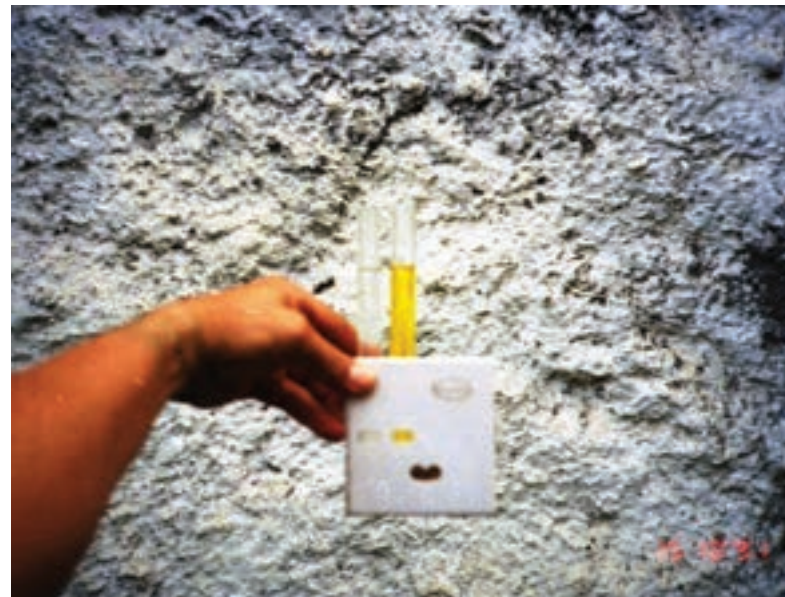
Εικ. 275. Μετρητής υπολείμματος ελεύθερου χλωρίου για μέτρηση τοπικά του χλωρίου στο νερό με το αντιδραστήριο της ορθοτολιδίνης
