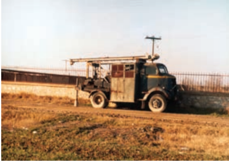
Εικ. 169. Αυτοκίνητο του συμμαχικού στρατού που το δαιμόνιο του Έλληνα το μετέτρεψε σε γεωτρύπανο στην υπηρεσία του ΟΥΘ
