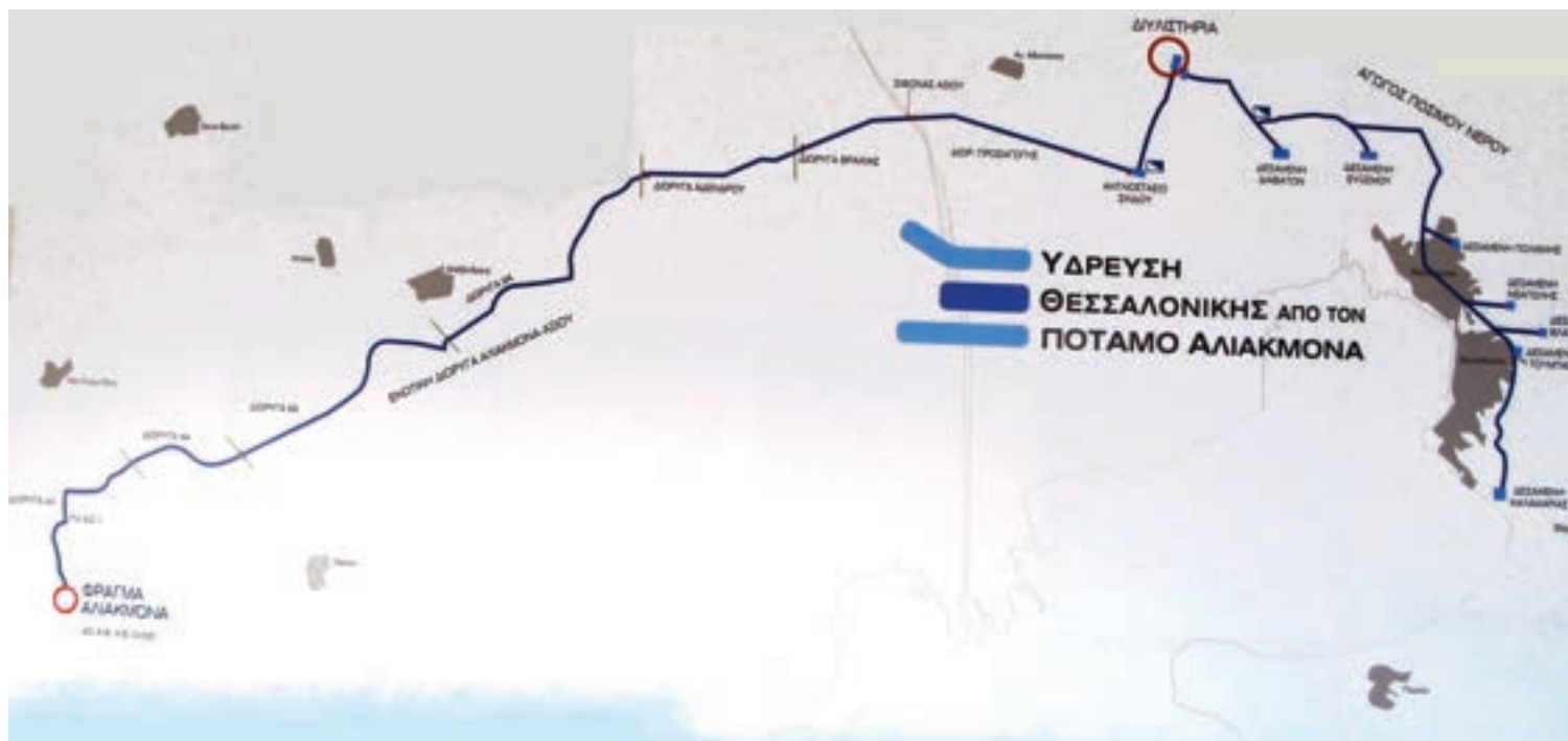
Εικ. 260. Χάρτης που δείχνει τη διαδρομή του υδραγωγείου (ανοιχτό κανάλι) από το φράγμα του Αλιάκμονα στην Αγία Βαρβάρα Βέροιας, μέχρι την Εγκατάσταση Επεξεργασίας Νερού (ΕΕΝ-Διυλιστήριο Ύδρευσης) στη Νέα Ιωνία, πίσω από τη Βιοχάλκο
