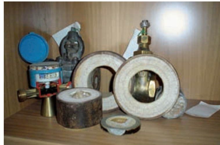
Εικ. 174. Αγωγοί με πουρί (ανθρακικό ασβέστιο) και ένα υδρόμετρο
