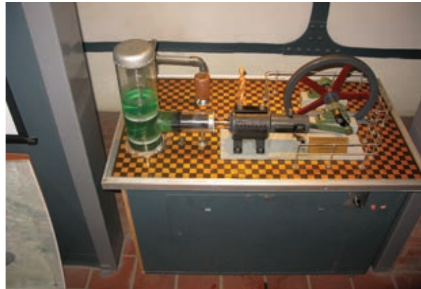
Εικ. 230. Μακέτα (μικρογραφία) ατμομηχανής με εμβολοφόρο αντλία, ίδιου τύπου με εκείνη που λειτουργούσε μέχρι το 1929 στο Κ.Α.Σ.
