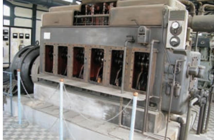
Εικ. 228. Το ηλεκτροπαραγωγό ζεύγος Buckeye αποκατεστημένο στο μουσείο
