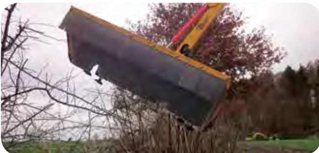
L'épaveuse à fléaux permet de tailler efficacement les haies basses.
