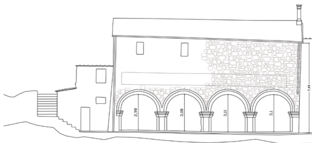
PROSPETTO LATERALE (VERSO IL FIUME) in scala 1:100
