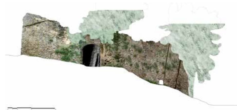
Analisi per il restauro delle mura, rilievo con "nuvole di punti" (progetto Giovanni Minutoli).
