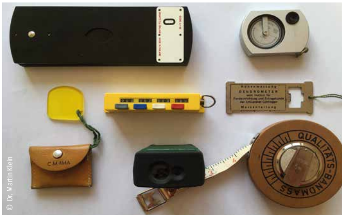
Bild 36: Forstliche Messgeräte, oben: Höhenmesser mit Abstandslatte, links: Winkelzählprisma, Mitte: Zählwerk, rechts: Kramersches Dendrometer, unten: Laserentfernungsmesser, Durchmessermaßband
