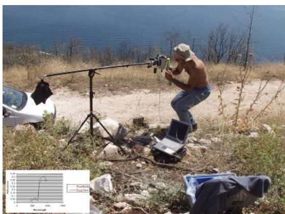
Συλλογή στοιχείων υπαίθρου με τη χρήση φασματοραδιόμετρου
