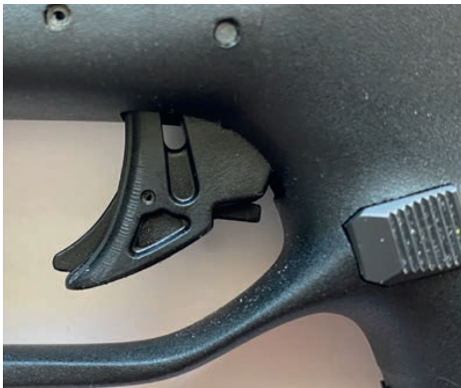
Die Abzugssicherung ist die einzige Sicherung am vollends gespannten Abzugssystem.
