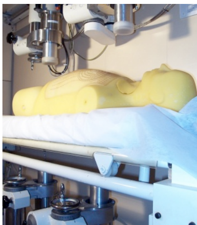
Ganzkörperzähler mit Kalibrierphantom
