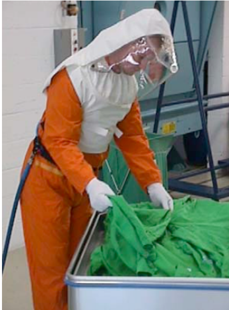
Vollschutzhaube mit Fremdluftzufuhr Quelle: ENS Nuclear Services GmbH
