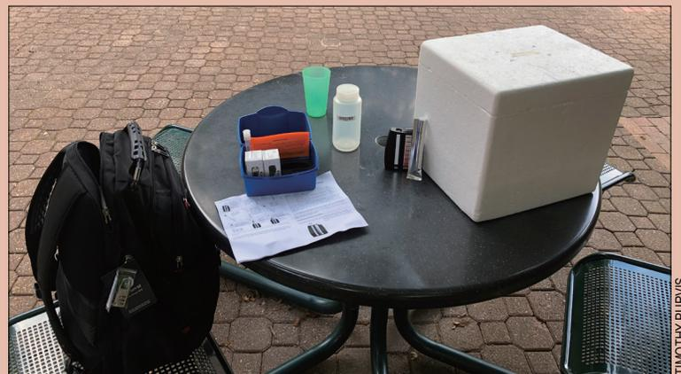
Exemple d'une station de mesure de terrain en cours d'utilisation. Les kits de terrain non utilisés sont rangés. Les papiers sont maintenus avec un objet.
