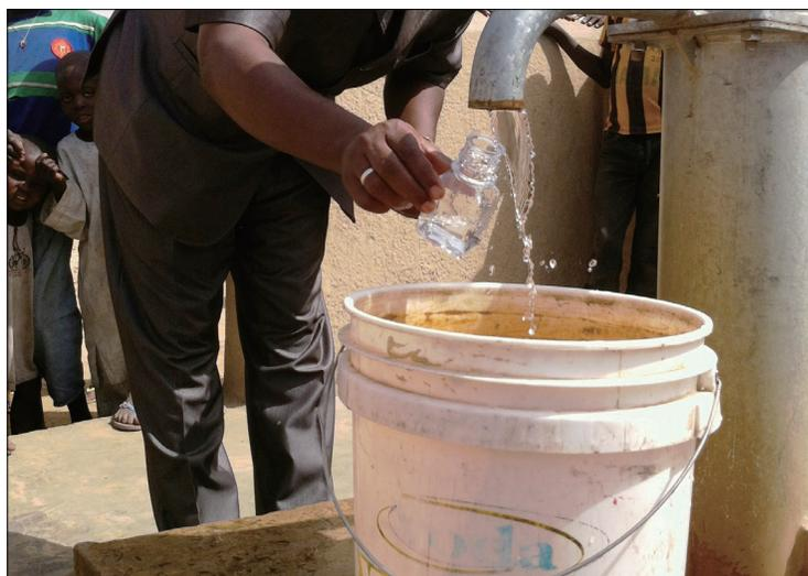
Prélèvement d'un échantillon d'une source d'eau
