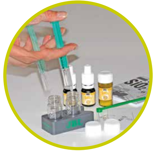
Mit der beigelegten Spritze beide Prüfgläser mit Probewasser füllen.
