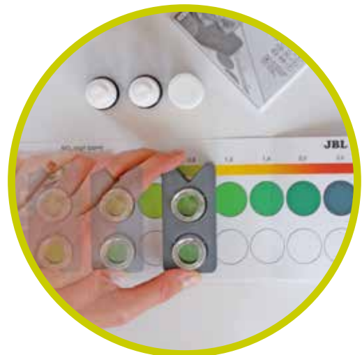
Komparatorblock mit der Einkerbung zu den Werten zeigend mit beiden Prüfgläsern auf der Farbskala hin und her bewegen, bis die Farbe der mit Reagens versetzten Probe der Farbe unter der Blindprobe bestmöglich entspricht.
