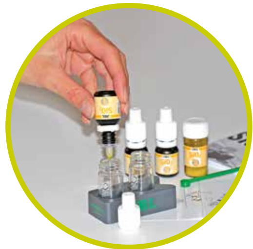
In eines der beiden Prüfgläser die Reagenzien zugeben.
