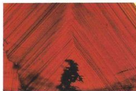
Abb. 15a, b: Wachstumsstruktur aus dem Pinakoid a und dem Prisma x, die Orientierung des Kristalls entspricht der in Abb. 14A gezeichneten Projektion. – Immersion, Abb. 15a 30×, Abb. 15b 50×.
