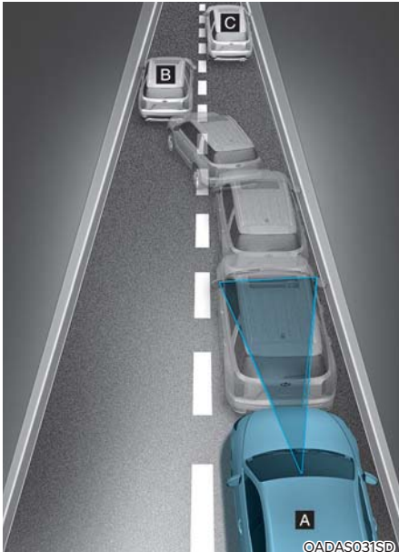
[A] : Ihr Fahrzeug, [B] : Die Spur wechselndes Fahrzeug, [C] : Fahrzeug in der gleichen Fahrspur
