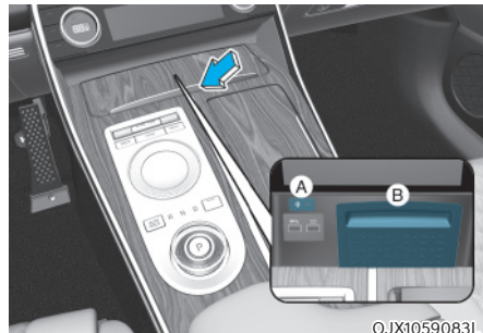
[A]: Kontrollleuchte, [B]: Ladekissen
