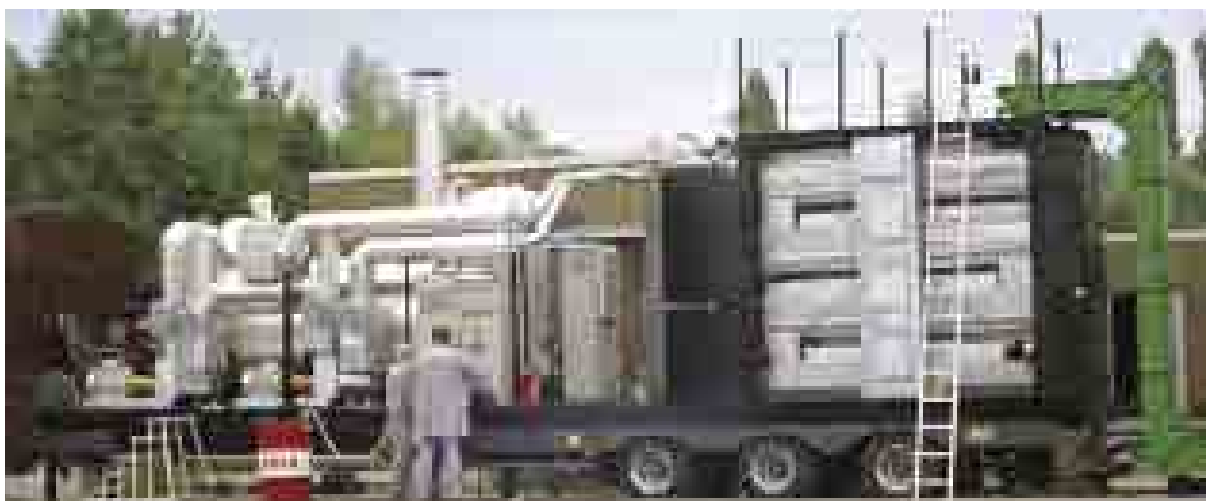
Mobilna instalacja suszarni osadów ściekowych
