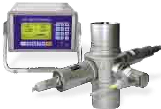
Fot. 4. Zestaw do pomiaru mętności model DTF16.
