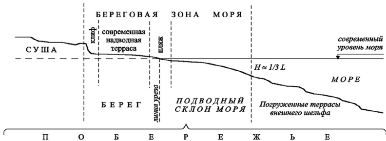
Рис 26. Схема расположения ведущих морфолого-структурных элементов береговой зоны морей и океанов на стыке Суши и Океана.
