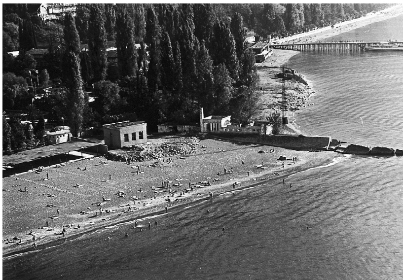
Рис. 62. Распределение отсепарированных пляжевых наносов во вдольбереговом потоке наносов в условиях влияния «глухого» искусственного препятствия и сквозного свайного пирса; район города Гагры, побережье Кавказа (фото В. М. Пешкова).
