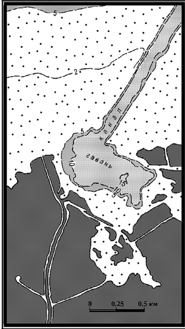
Рис. 72. Антропогенное преобразование дна Жебриянской бухты путем создания ковша гавани и подходного канала к порту Усть-Дунайск, Черное море. Изобаты – метры (устьевая область Дуная со стороны Жебриянской бухты на стыке дельты и коренного морского берега). Точками обозначены отмели прилегающей части моря.
