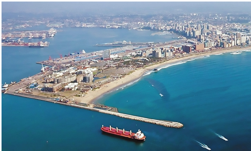
Рис. 79. Порт Дурбан, Южная Африка, побережье Индийского океана. Сквозь косу прорыт судоходный канал (глубина около 9 м, огражден молами), по которому крупное грузовое судно заходит в порт.
