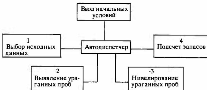
Рис. 3. Формальная структура блока оперативного подсчета запасов
