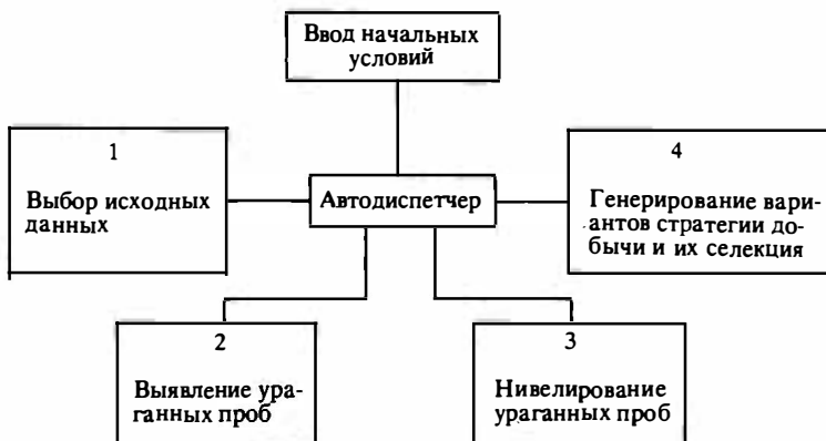
Рис. 4. Формальная структура блока планирования горных работ
