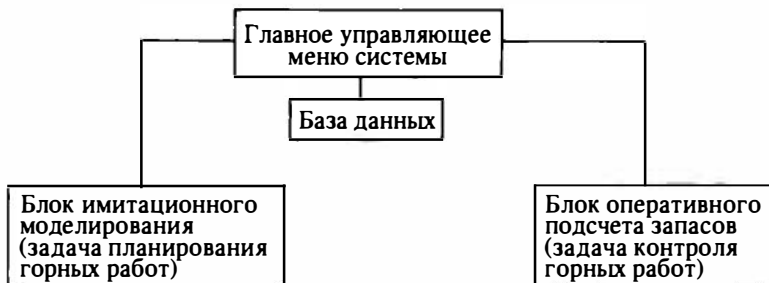
Рис. 2. Формальная схема компьютерной диалоговой системы контроля и планирования горных работ
