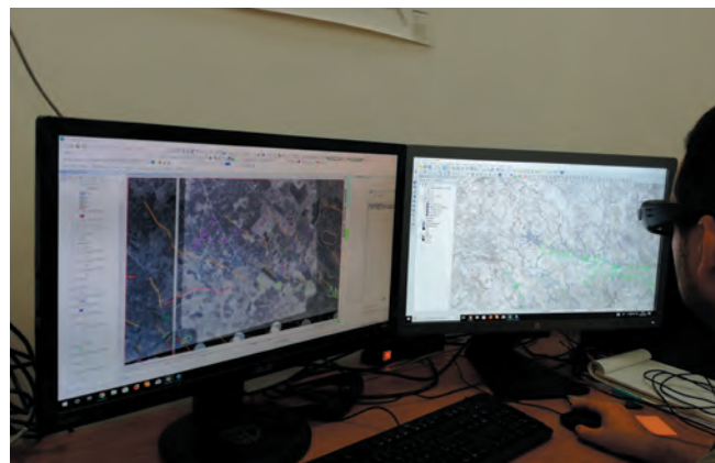
Figura 2 - Stazione fotogrammetrica utilizzata per la realizzazione delle carte geomorfologiche
