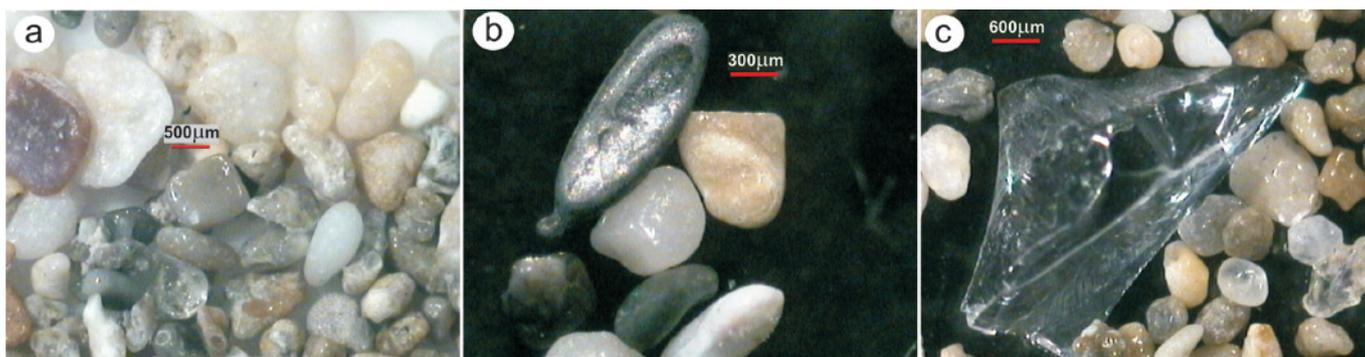
Figura 6 - Caratteri delle sabbie analizzate al microscopio ottico binoculare. a. Trattenuto ai 500 µm, si riconoscono numerosi clasti calcarei (litoclasti provenienti da rocce più antiche) e numerosi granuli di quarzo. b. Un frammento levigato di metallo proveniente da un oggetto di bigiotteria (orecchino, collana). c. Un grande frammento di vetro trasparente (proveniente da una bottiglia).
