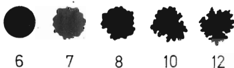
▲ Obr. 4. Stupnice pro stanovení členitosti i kulovitých útvarů porovnáváním Fig. 4. A graticule for the determination of the degree of articulation of rounded particles.
