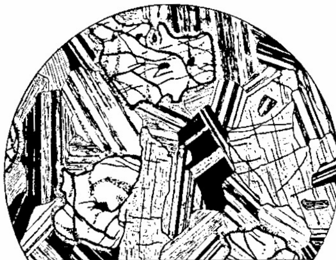
Obr. 3. Gabrově zrnitá struktura olivinického gabra tvořené hypidiomorfně omezeným plagioklasem (polysynteticky zdvojitělá zrna - toto zdvojitění je naznačeno střídáním bílých a černých lamel v jednotlivých zrnech), pyroxenem (zrna s kolmo se protínajícími štěpnými trhlinami) a alotriomorfním až hypidiomorfním olivínem (výrazná zrna s nepravidelně probíhajícími trhlinami). Šířka obrázku 5 mm.
