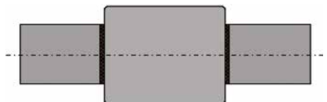
Schweißfehler außen – Ungenügendes Schälen
