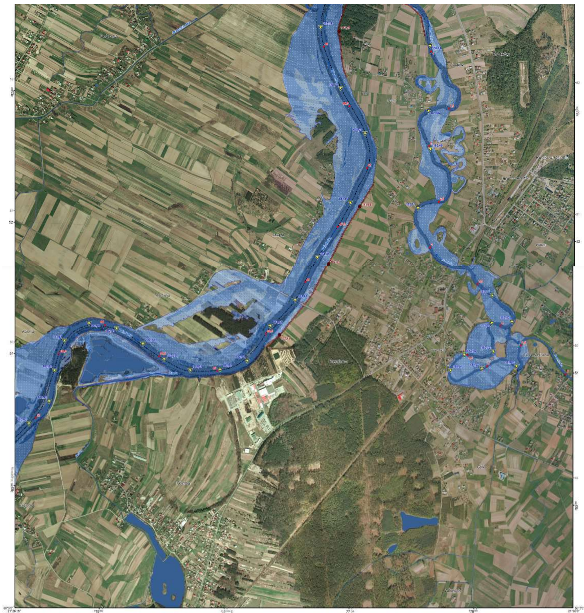
Mapa 36. Mapa zagrożenia powodziowego wraz z głębokością wody, prawdopodobieństwo wystąpienia powodzi 10% – raz na 10 lat (ArkuszM-34-67-D-b-4).
