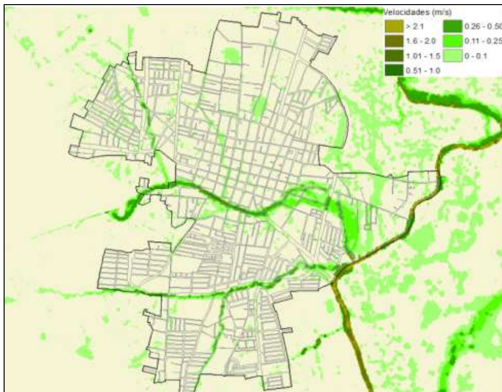
Figura 5.23 Mapa de velocidades máximas alcanzadas para un periodo de retorno de 5 años
