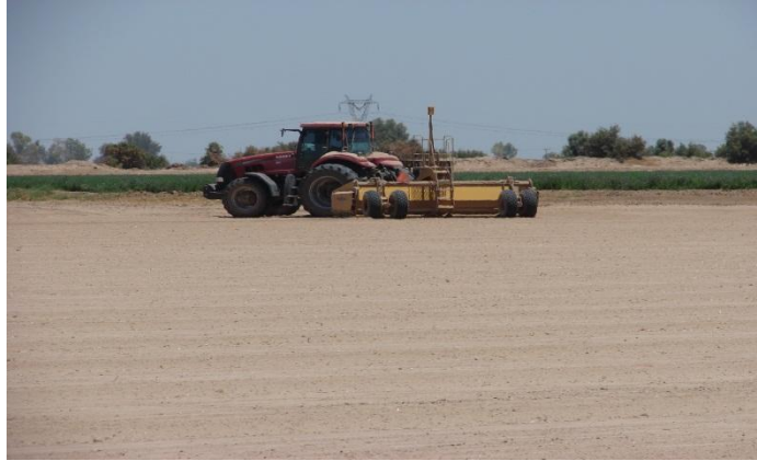
Figura 5. Equipo para nivelación de suelos agrícolas con la tecnología láser.
