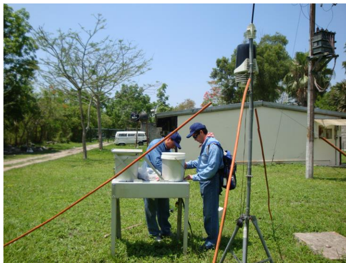
Figura 15. Estación para el depósito atmosférico, El Tajín
