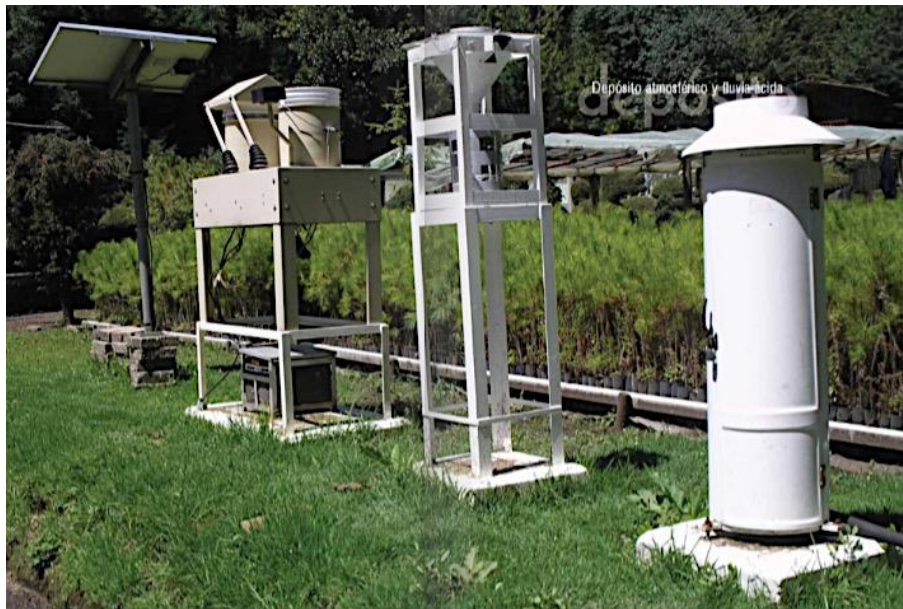
Figura 93. Equipos para el muestreo de depósito atmosférico, SEDEMA 2011.
