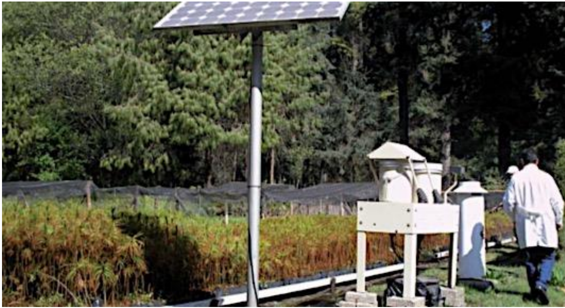
Figura 34. Equipo de muestreo utilizado por la SEDEMA para el depósito atmosférico.
