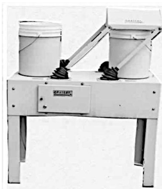
Figura 79. Colector automático para el agua de lluvia usado por SEDEMA 1997.
