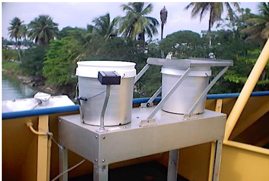
Figura 13. Equipo para el muestreo de lluvia en el crucero oceanográfico de 2003.
