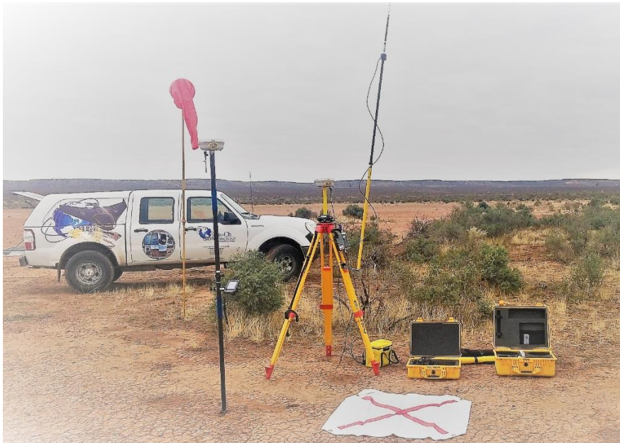
Figura 04: Movilidad, cono de viento, receptor GNSS, dianas, equipo UAV (parte del equipo necesario para AFI)
