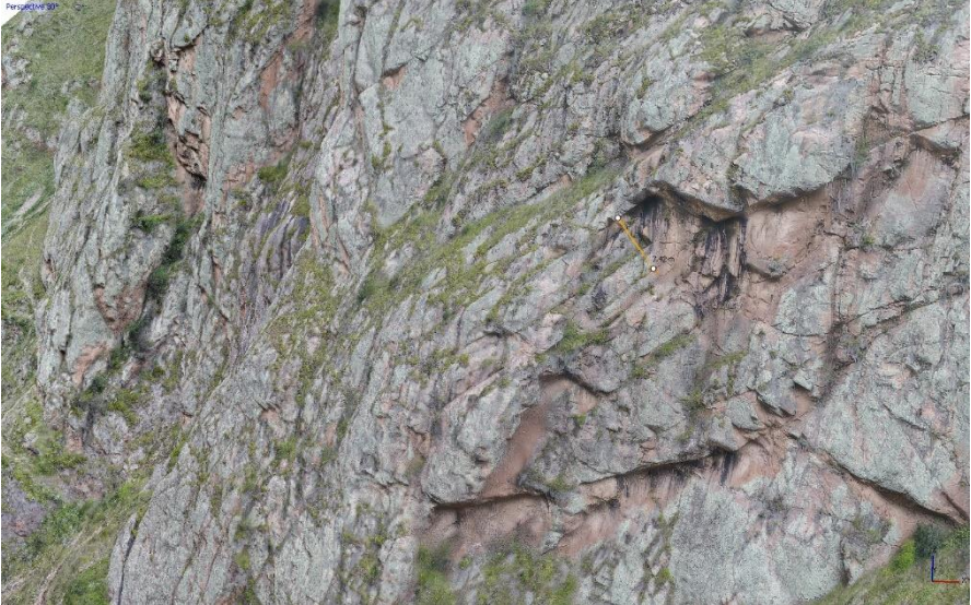
Figura 40: Modelo 3D de macizo rocoso generado a partir de aerofotogrametría con drones, medición de espaciamiento de diaclasas.
