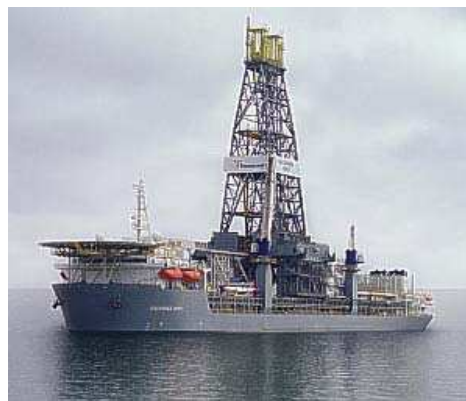
Εικ. 5.4. Παραδείγματα (α) μιας ημι-υποβρυχίας εξέδρας και (β) μιας πλωτής εξέδρας (drillship).
