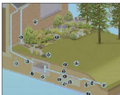
Trincee di infiltrazione
