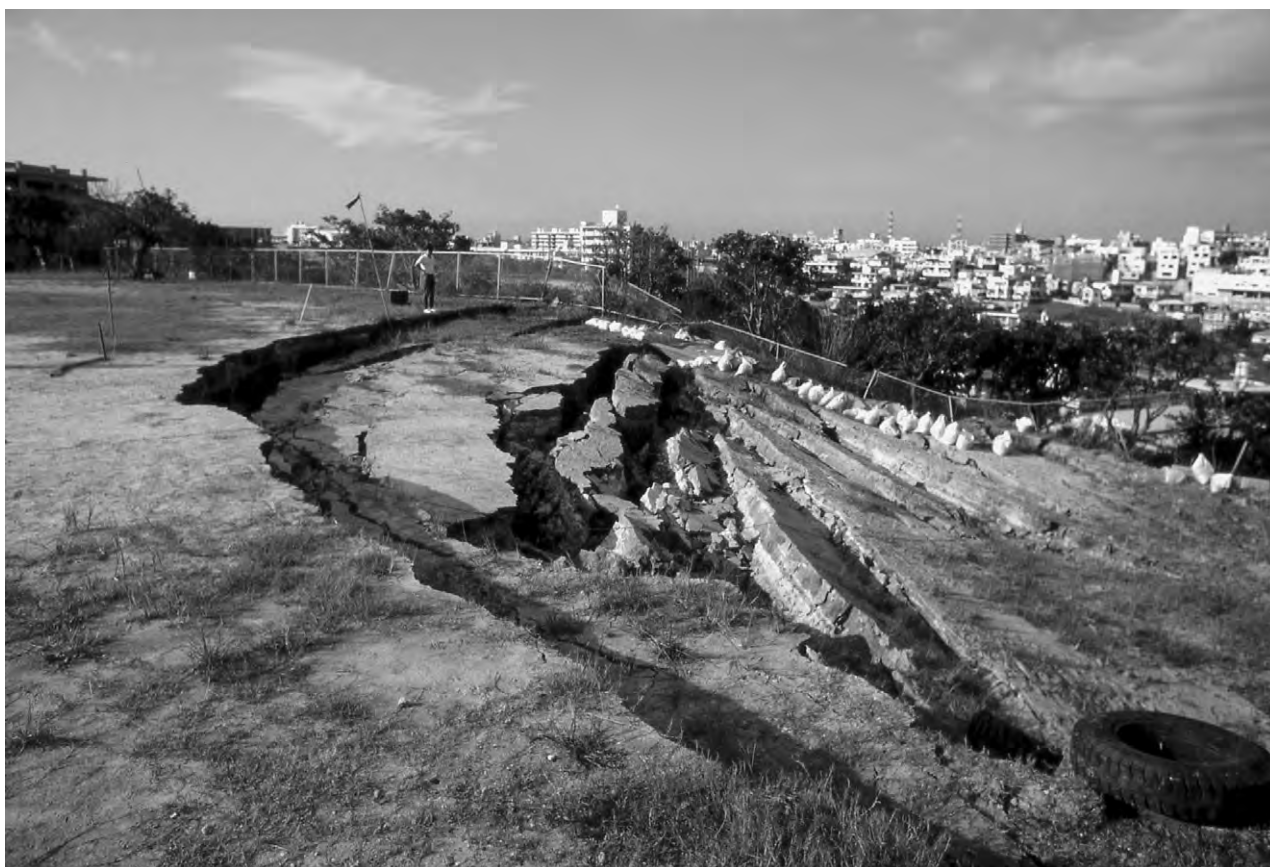
第11.1図 地すべりの滑落崖 浦添職業訓練校前庭にて1991年10月3日撮影。
