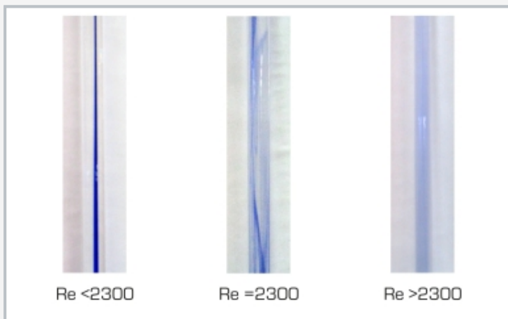
Strömungszustände von links nach rechts: laminare Strömung, Übergang von laminarer zur turbulenten Strömung, turbulente Strömung
