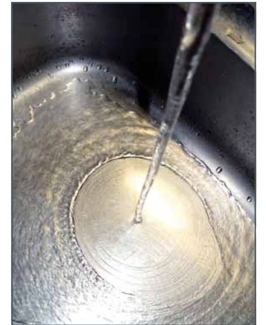
Resalto hidráulico en una pila
