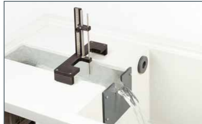
Caída sobre cresta delgada en el vertedero de aforo
