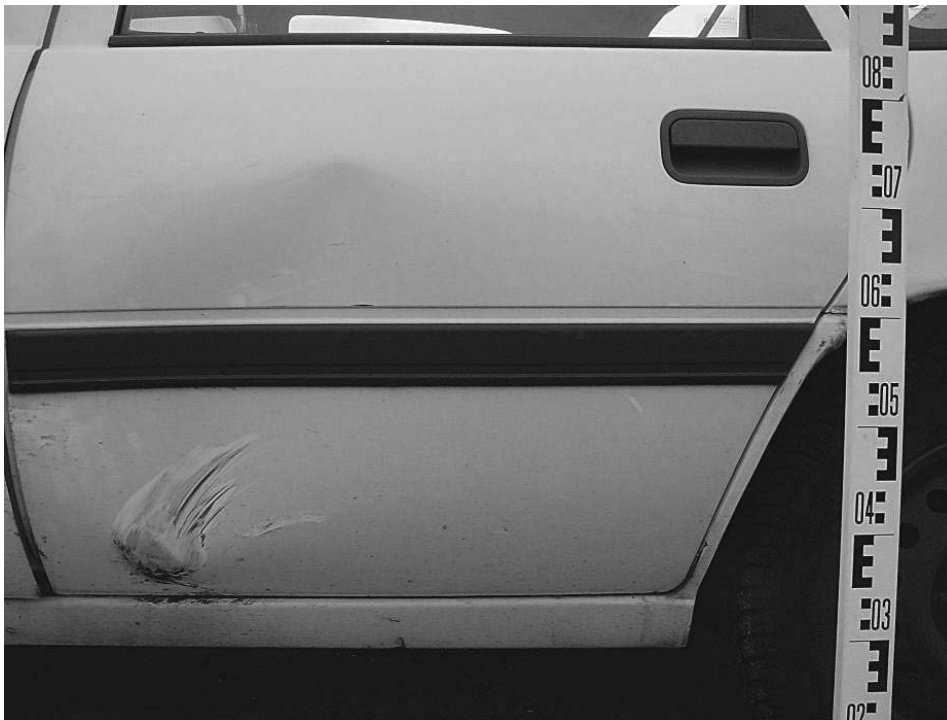
Abb. IV-5: Reifenanrieb an spurwechselndem Fahrzeug
