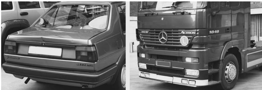
Abb. V-3: Obwohl die Front des Lkw fast völlig eben ist, kann sie den scharfen Knick am Heck des VW Jetta verursacht haben.
