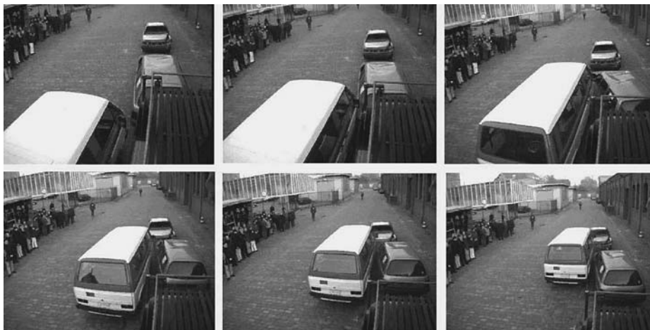
Abb. V-7: Bei dem Unfallversuch schiebt der schwere VW-Transporter den hinteren Pkw beiseite und stößt dann gegen den davor stehenden.
