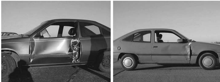
Abb. IV-8: Die Tür des linken Pkw wurde geöffnet und schlug gegen die Seite des vorbeifahrenden rechten Pkw
