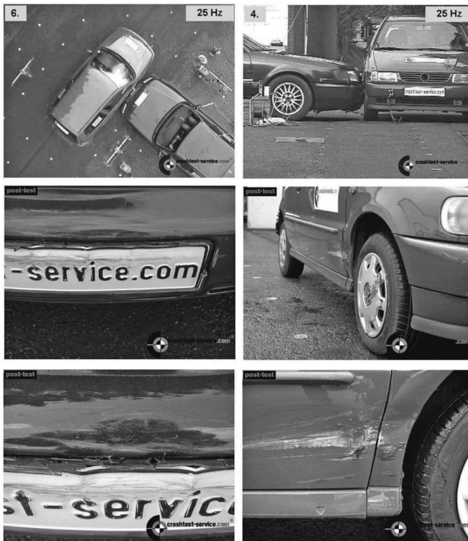
Abb. IV-14: Versuch zur Bemerkbarkeit einer mit Bremsen überlagerten Kollision im fließenden Verkehr (Bilder: crashtest-service.com)
