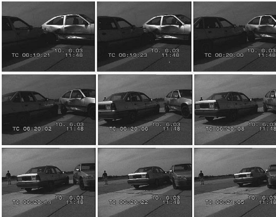
Abb. III-11: Unfallversuch mit zwei bewegten Pkw
