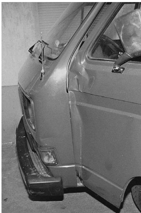
Abb. IV-7: Typischer Schaden durch Umschlagen einer Tür nach vorne
