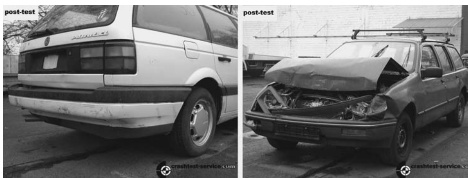
Abb. III-9: Unterschiedliche Schäden bei derselben Kollision (Quelle: crashtest-service.com )
