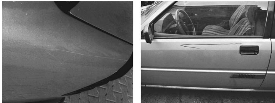
Abb. V-8: Links: Als Fahrradschaden geltend gemachter Kratzer. Rechts: Bei Kollisionsversuch erzeugtes Spurenbild
