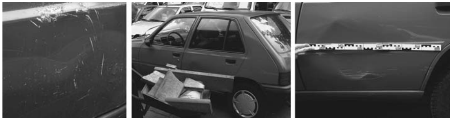
Abb. V-9: Unterschiedliche Schäden durch Schubkarren
