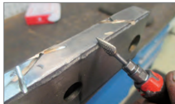
4 Blankfräsen der Schneidkante
