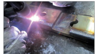
5 WIG-Auftragschweißen am Teilsegment des Schneidstempels
