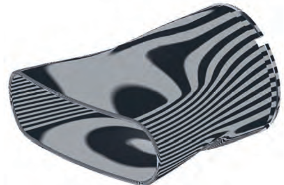
5 Reflexionsanalyse der Oberfläche der Ondulierdüse
