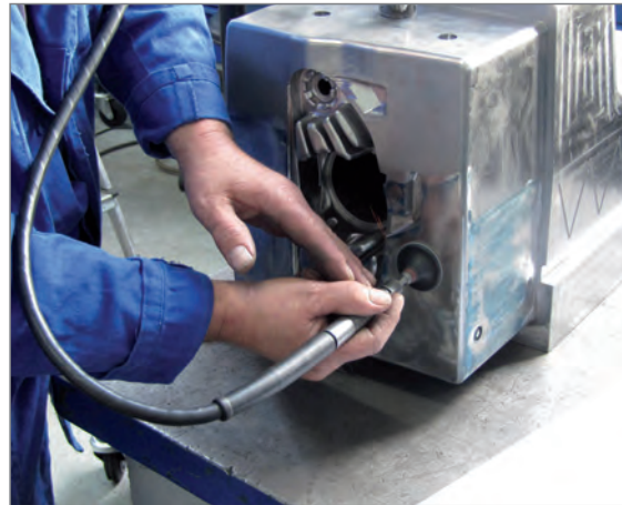
2 Abtragen der Druckstellen mit dem Handschleifgerät
