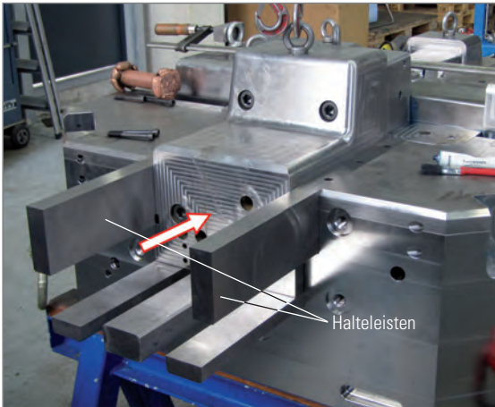
1 Schieber drückt in vorderer Endlage gegen die beteiligten Trennflächen
