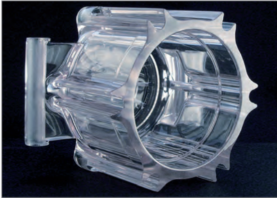
1 Glasklarer Prototyp, hergestellt mithilfe der Stereolithographie
