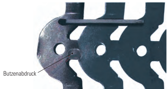
5 Fertigungsfehler durch mitgewanderten Butzen
