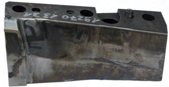
2 Verschleiß an Tiefziehwerkzeugbauteil
