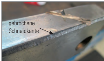
3 Abgebrochene Schneidkante am Teilsegment eines Schneidstempels
