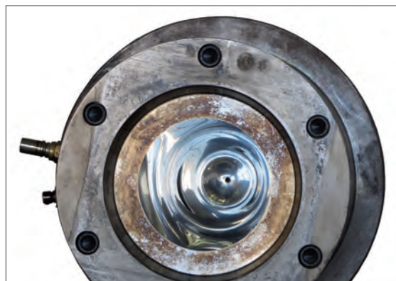
1 Hartverchromte Kavität eines gebrauchten Formeinsatzes
